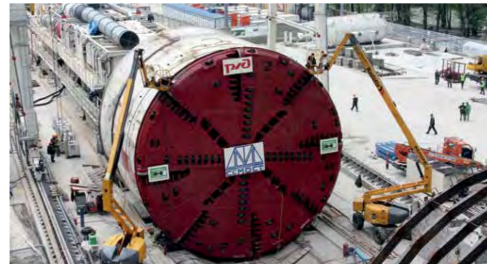
Тоннельно-проходческий комплекс для бурения тоннелей Herrenknecht 13210 HART A tunnel-boring machine
