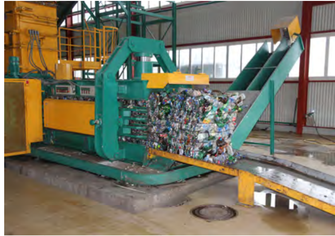
Прессование блока пластиковых отходов Pressing block of plastic waste
